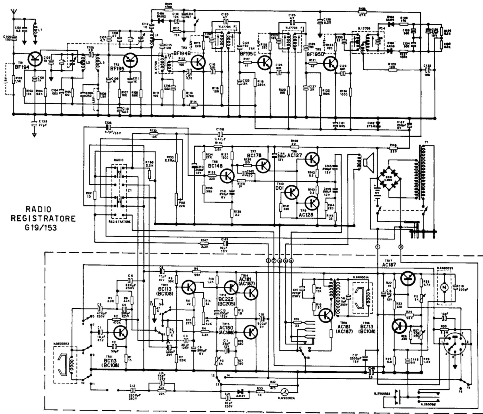
**NOTA** - Per alimentazione con accumulatore auto a 12 volt, usare tassativamente il cavetto riduttore-stabilizzatore N. 20/32.
